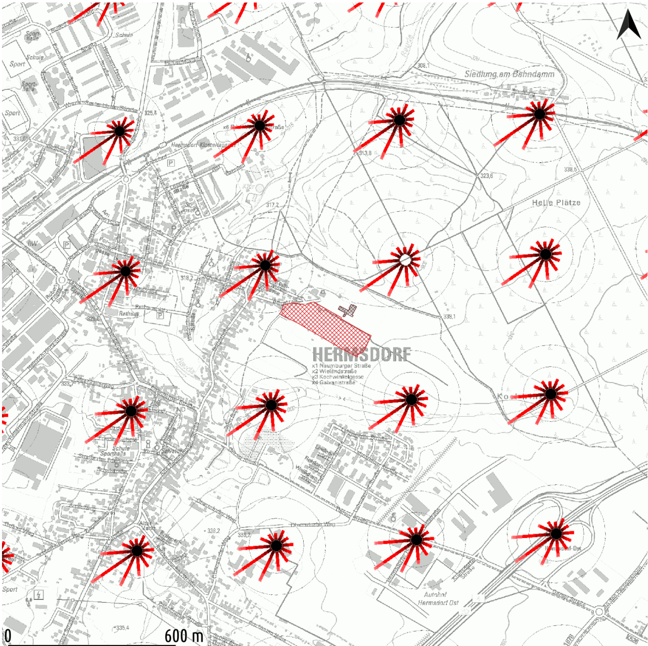
Abb. 8: synthetische Windverteilungen auf der Basis von METRAS-Simulationen (rosa-rot-braune Balkendiagramme mit zumeist schwarzem Zentrum) gemäß [Lit. 20] im Bereich 2304 x 2304 m 2 von {32700404;5641218} bis {32702708;5643522}, Maschenweite 200 m | Kartengrundlage: DTK, TLBG
