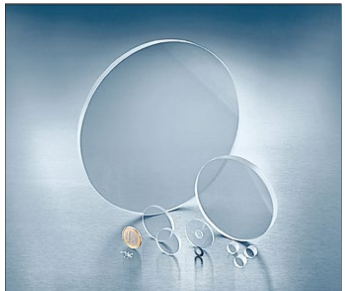
Im neuen F&E-Zentrum kann Transparentkeramik für unterschiedliche Anwendungen in verschiedenen Geometrien im Pilot- und Serienmaßstab hergestellt werden.
