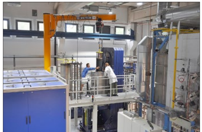
Ein Kernstück der zahlreichen Anlagen im F&E-Zentrum ist die Heiß-Isostatische Presse (HIP). Hier werden die keramischen Bauteile bei bis zu 2000 °C und 2000 bar thermisch nachverdichtet - ein wichtiger Schritt bei der Erzeugung der Transparenz.
